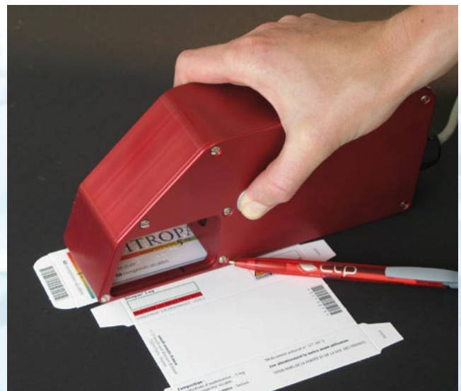
Le capteur Braille mis au point par le CTP soutenu par la Région Rhône-Alpes
