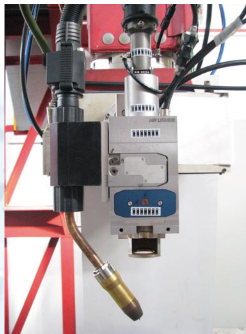
Tête de soudage hybride robotisable, développée par Air Liquide
